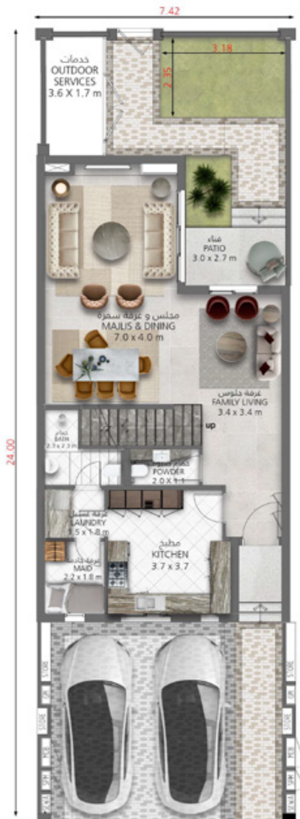
الطابق الأرضي Ground Floor
